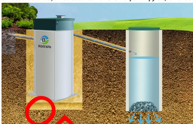
Диаметр отводящего трубы русла принимается от 110 мм и более.
