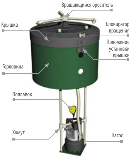
Рисунок 17. Установка циркуляционного насоса Станции.
