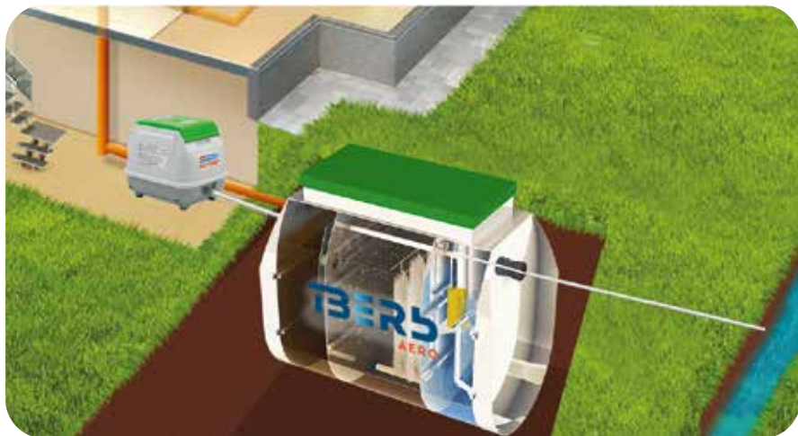
1. Схема с напорным отводом очищенной воды
