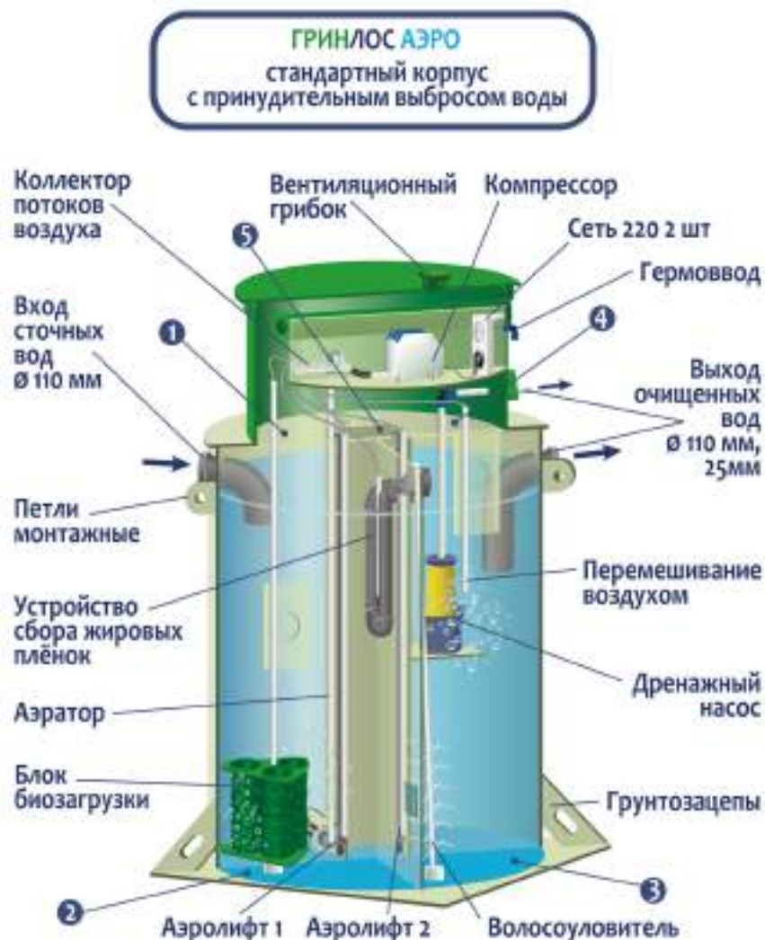
Рисунок 7. Схема Изделия ГРИНЛОС АЭРО с принудительным сбросом (стандартный корпус).
