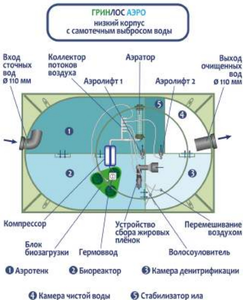
Рисунок 4. Технология очистки стоков в моделях ГРИНЛОС АЭРО с самотечным сбросом (низкий корпус).
