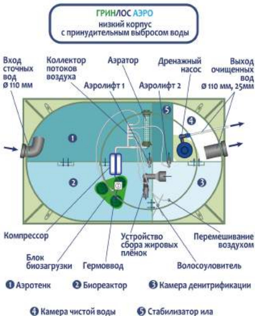
Рисунок 5. Технология очистки стоков в моделях ГРИНЛОС АЭРО с низким корпусом с принудительным сбросом (низкий корпус).
