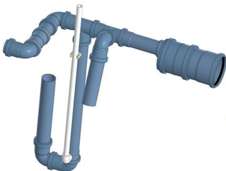
Рисунок 4 - Аэрлифт очищенной воды при принудительном отведении
