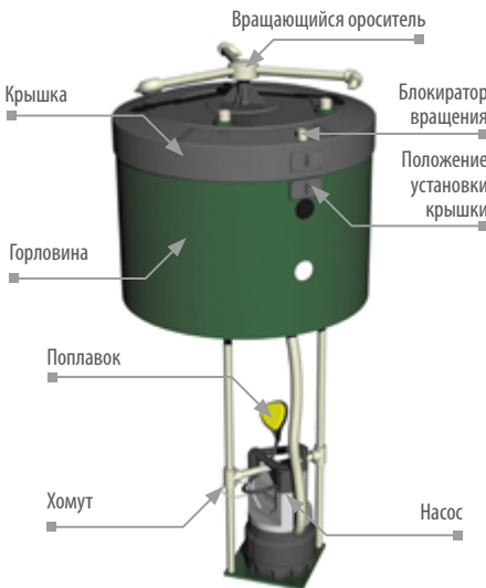
Рисунок 17. Установка циркуляционного насоса Станции.
